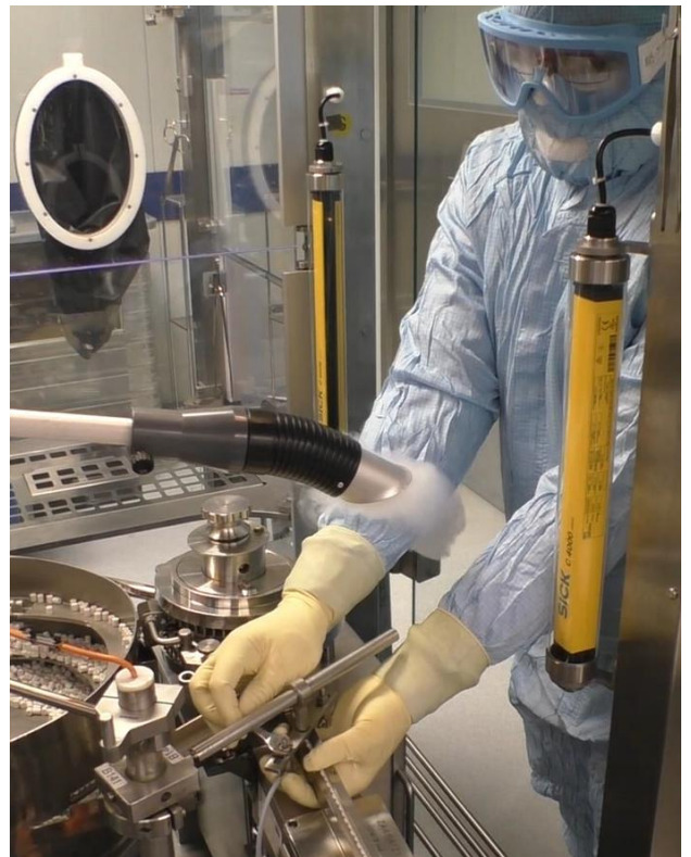
Strömungsvisualisierung beim Personaleingriff an einem RABS
